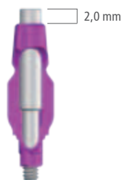
A rögzítőcsavar kb. 2,0 mm-rel kinyúlik a helyesen beillesztett műcsonkból a becsavarás előtt.
