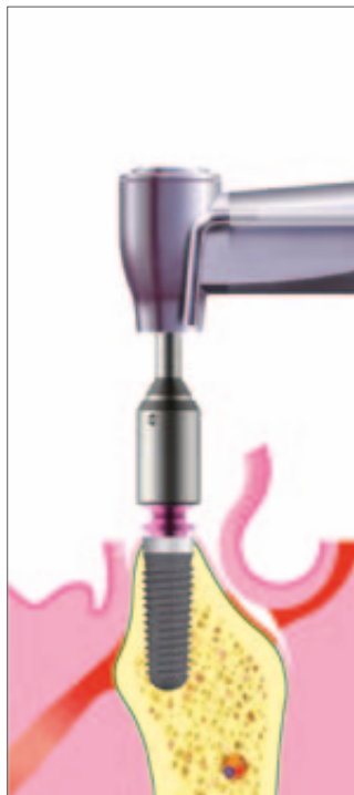
A Gépi behajtás becsavaró műszerrel csavarimplantátumhoz ISO szárral (max. 15 f/perc)
